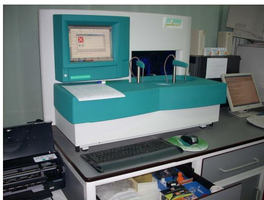
Foto: analizzatore multiparametrico per chimica clinica in dotazione al laboratorio
